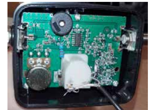
Bild 3: Anschluss der Kabel zum Spannungsmesser
