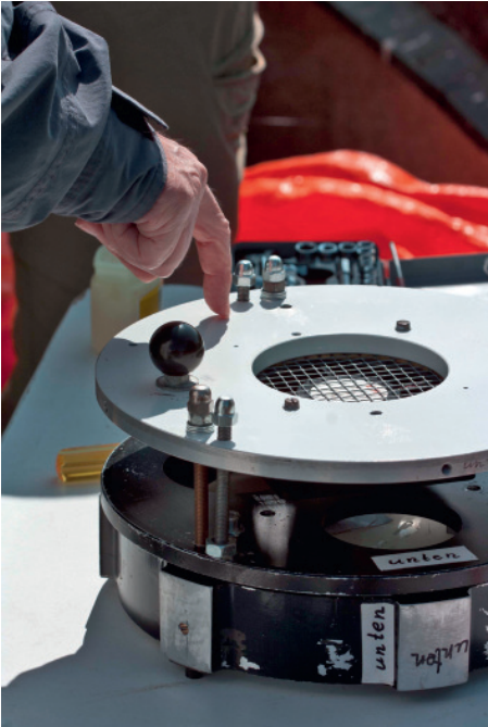
Abbildung 2: Ausgebaute Spiegelzelle der Astrokamera, mit den Justageschrauben und dem Lüfter
