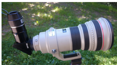
Abb. 4: Teleobjektiv als Fernrohr
