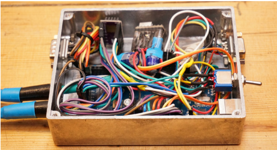
Komplette Steuerung mit 15 poligen Steckanschluss für den Handtaster (rechts) und entsprechendem Autoguidereingang links.
