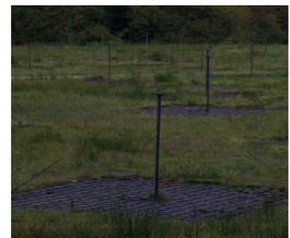
Hiermit kann die Frühzeit des Universums erforscht werden! Die Einzel-Antenne der Anlage ist an einem Mast befestigt. Es gehen von der Mastspitze vier Dipol-Antennen im 45 Grad-Winkel zum Boden. Diese Dipol-Antenne erinnert mich an meinen eigenen Hobby-Radioastronomie-Antennenbau „Radio Jove“. Eine Antenne für den Empfang des Gasriesen Jupiter. (Weitere Infos zum Antennenbau im Bereich Hobby-Radioastronomie siehe unten).
